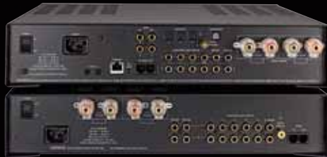
Majik-I (u.) und Majik DS-I (o.): Deutlich erkennt man, dass sich die Amps stark ähneln. Allerdings sind die Endstufen des neuen anders angeordnet, und es gibt mehr und auch digitale Anschlüsse
