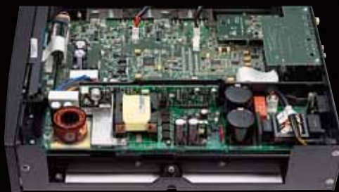
Wie in allen aktuellen Linn-Geräten findet auch im DS-I das neue Dynamik-Netzteil (v.) Verwendung
